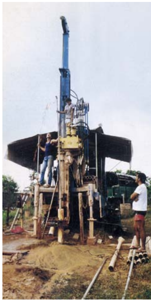
Die neue Brunnen-Bohrmaschine, bis 150 m tief kann gebort werden. Ein Geschenk aus der Schweiz und Italien von Saverio Mondini und seinen Freunden.
